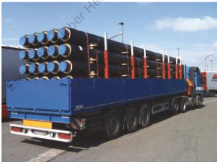
Die Lagerung der Rohrstangen auf dem LKW hat mit ausreichend breiten Holzzwischenlagen zu erfolgen und gewährleistet somit ein sicheres und beschädigungsfreies Abladen.
