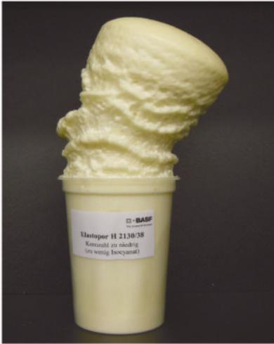
Ein Überschuss an Polyol führt zu einer weichen Schaumstruktur und zu einer deutlich geringeren Rohdichte. Am Schaumbecher in Abb. 59 erkennt man den dramatischen Einfluss auf die Schaumqualität. Auch hier kann es, wie bei zu hohen Temperaturen (s.o.), zu einer Überfüllung und dem Aufplatzen der Muffe kommen.
