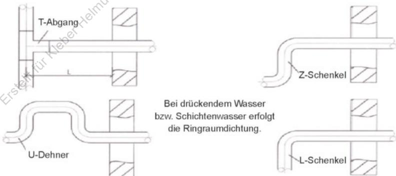
Abbildung 4, Einführung von spannungsfreien Systemen
