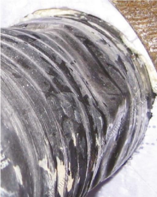
Abbildung 86. Mantelrohrdeformation durch falsche Auswahl der Ringraumdichtung
