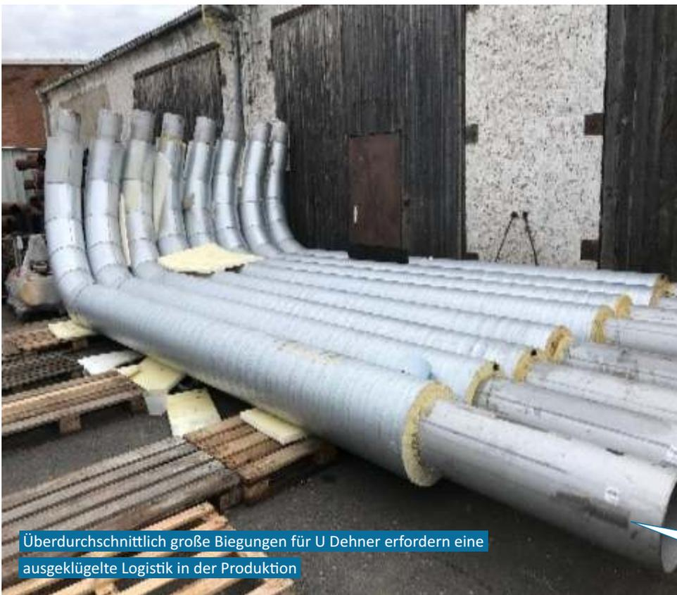
Überdurchschnittlich große Biegungen für U Dehner erfordern eine ausgeklügelte Logistik in der Produktion
