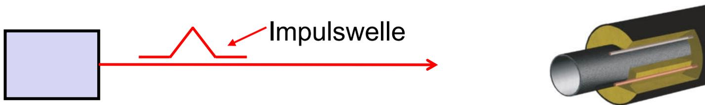
Änderungen des Wellenwiderstandes (Leitungsimpedanz) führen zu Teilreflexionen des Impulses bis hin zu Totalreflexionen, die vom Ortungsgerät empfangen, analysiert und angezeigt werden.
